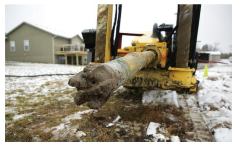
**ACCESSORI ROBUSTI.** Grazie alla curvatura a 2° posta nella parte anteriore dell'accessorio, la nuova testa di perforazione RH10 ingrassabile permette una sterzata reattiva al comando di guida, per installazioni di precisione.
