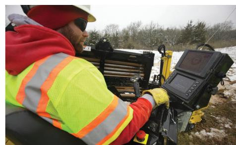
**PERFORAZIONE TRANQUILLA.** Seguendo le linee guida della gamma S3, il D23x30DR S3 produce un'emissione sonora pari a 83 dB(A) (62 db(A) con cabina), ottimizzando quindi la comunicazione della squadra e creando un ambiente di lavoro tranquillo, che riduce il disturbo degli abitanti dei quartieri residenziali e delle aree urbane più densamente abitate.
