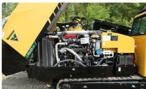
**POTENZA IMPRESSIONANTE.** Grazie ad un motore diesel John Deere da 140 hp (104 kW), questo perforatore lavora con una capacità di tiro/spinta di 40.000 lb (177,9 kN) e una coppia di torsione di 7.457 Nm (5.500 ft-lb).
