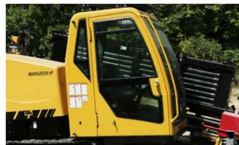
**PIU' COMFORT.** Lavora con un comfort maggiore grazie ad una cabina standard con aria condizionata, a prova di intemperie e ad emissioni sonore ridotte pari a 80 dBA all'orecchio dell'operatore.
