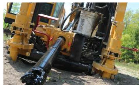
**MENO RESTRIZIONI.** Il design cavo dell'asta interna permette un flusso maggiore di aria e fluidi verso la testa di perforazione durante la realizzazione del foro pilota e in fase di tiro. Ciò permette all'operatore di scegliere tra diverse opzioni di attrezzatura, incluso martelli ad aria e alesatori più larghi.
