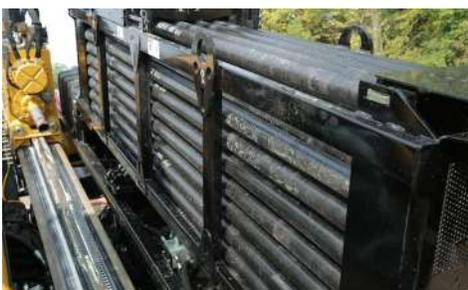
**PIU' ASTE A BORDO.** Installa più metri e risparmia tempo grazie alla capacità di ben 152,4 m (500') di carico aste a bordo.
