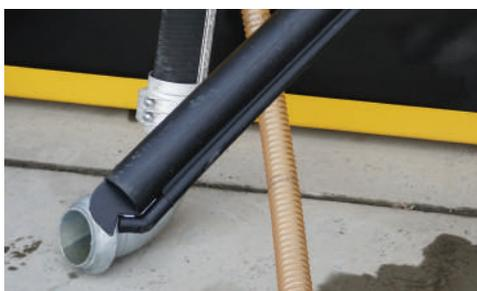
**MISCELAZIONE TOP.** Il sistema di miscelazione è equipaggiato con un potente tubo di aspirazione della bentonite, in grado di processare in modo rapido anche le big bag. Un agitatore da 2.2 kW garantisce una miscelazione ottimale.
