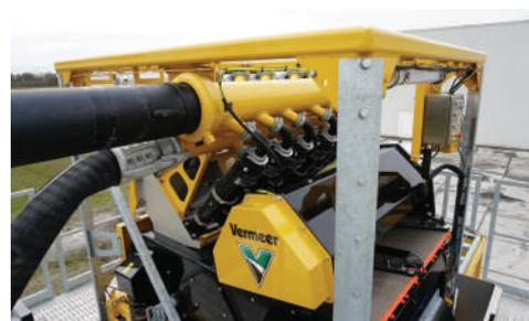
**SEPARAZIONE OTTIMALE.** Elevate prestazioni nella separazione dei solidi grazie a 12 idrocycloni Krebs a corpo lungo da 4 pollici in abbinamento ad un'area di vagliatura piuttosto ampia.
