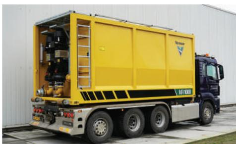
**DIMENSIONI COMPATTE E TRASPORTO EFFICIENTE.** Creato sulle dimensioni di un container ISO da 20 piedi, le dimensioni di trasporto di questa unità sono ridotte. Il modulo con vibrovaglio è alloggiato all'interno della vasca attiva. Durante il montaggio, questo modulo può essere sollevato all'esterno e installato semplicemente ruotandolo di un quarto di giro.
