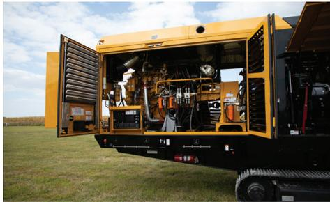
**ACCESSO AL VANO MOTORE.** L'LS3600TX offre un accesso ai vani macchina senza paragoni. Il vano motore è facilmente accessibile e comodo per la manutenzione, presentando cofani di accesso larghi, differenti punti di salita e una piattaforma ampia per facilitare il lavoro.
