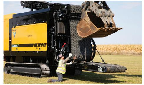
**ACCESSO AL NASTRO INFERIORE.** Riduci i tempi di manutenzione grazie a un nastro inferiore unico, che può essere rimosso senza staccare o separare il nastro di scarico.
