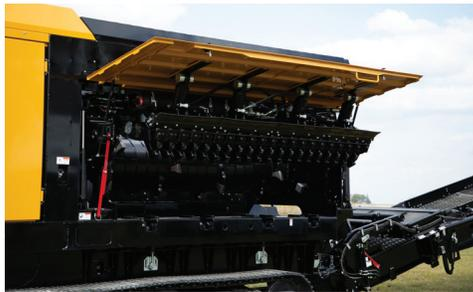
**ACCESSO COMPLETO AL ROTORE.** Il vano laterale ad apertura idraulica garantisce un accesso completo al rotore, al pettine e al nastro inferiore per ridurre i tempi di manutenzione. Quest'area è stata progettata per permetterti di compiere gli interventi necessari senza ostacoli.
