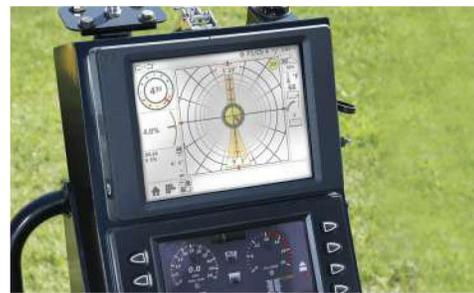
**DISPLAY TOUCH AURORA™.** Il display a colori interattivo fornisce dati in tempo reale facili da interpretare e localizzare nonché piani di perforazione, contribuendo ad incrementare la produttività.
