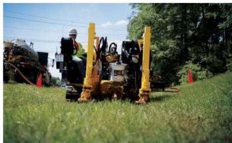
**MASSIMA EFFICIENZA.** Con 124,6 kN di spinta/ tiro-posa e 5.694,4 Nm di coppia di rotazione, il D24x40 S3 presenta un grande miglioramento rispetto al suo predecessore, contribuendo a massimizzare la produttività della macchina e del cantiere.
