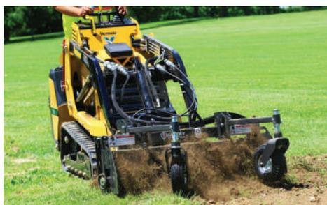
**COSTRUITA PER RESISTERE.** Ottieni di più ogni giorno grazie a una capacità di sollevamento di 1.198,8 kg e una capacità operativa nominale di 419,6 kg, raggiungendo una altezza massima al carico della benna pari a 2,1 m.
