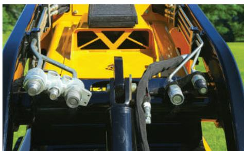
**SPINTA IDRAULICA.** La minipala S925TX è equipaggiata con un sistema idraulico doppio con sistema ad alto flusso per gli accessori più impegnativi ed un sistema a basso flusso per dare all'operatore il massimo controllo.
