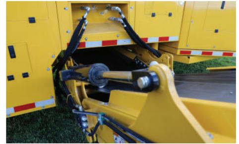
**FLESSIBILITA' IN CANTIERE.** Il sistema ausiliario idraulico permette al vaglio TR6450 di utilizzare il terzo nastro opzionale senza difficoltà.
