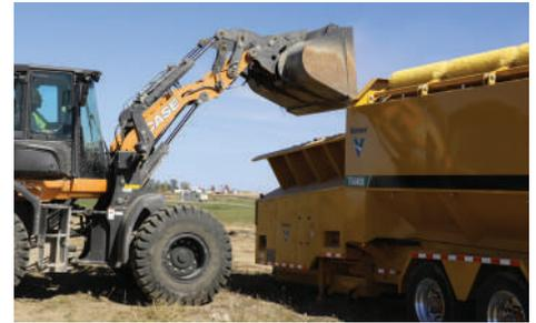
**ALTEZZA DELLA TRAMOGGIA COMODA.** Grazie ad una altezza di carico della tramoggia pari a 2,9 m (9,5 ft), l'operatore può caricare il materiale senza bisogno di rampe di accesso alla macchina, riducendo i cicli di carico di materiale.
