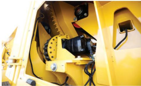
**SISTEMA DI TRASMISSIONE TAMBURO OTTIMIZZATO.** Un sistema di trasmissione con catena su pignone a trasmissione idraulica permette lo smontaggio del tamburo dalla sede in maniera veloce per facilitare gli interventi di manutenzione. Il sistema Load Sense del tamburo garantisce al tamburo di raggiungere la capacità massima fermando automaticamente l'alimentazione della tramoggia in caso di eccesso.
