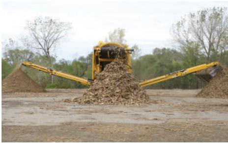
**CONFIGURAZIONE A 3 SELEZIONI.** Grazie alla possibilità di scelta del terzo nastro opzionale, con il vaglio rotativo TR6450 è possibile selezionare fino a tre prodotti da un unico materiale in entrata.
