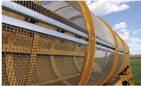
**GRIGLIE IN TENSIONE.** Grazie alla capacità di tendere le griglie del vaglio intorno al tamburo, l'operatore può aggiungere rigidità ottimizzando la produzione. In applicazioni con umidità molto elevata, l'uso di griglie in acciaio inossidabile può essere molto utile.
