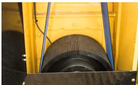
**POTENZA DOVE SERVE.** Il sistema meccanico a trasmissione a cinghia massimizza la potenza al tamburo rispetto ai sistemi a trasmissione idraulica. La ventola Flexaire si regola in automatico in base alla temperatura, mettendo a disposizione più hp per il rullo..
