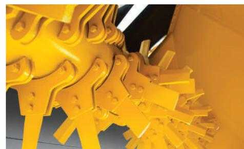
**DESIGN DEL TAMBURO OTTIMIZZATO.** La lunghezza notevole delle palette riduce il trascinarsi del materiale e protegge la superficie del tamburo. Il design innovativo permette una migliore ossigenazione e porosità del prodotto.
