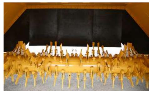
**PARTI D'USURA RESISTENTI.** La struttura del rivoltatore è costituita da piastre in acciaio da 6,4 mm per garantire maggiore protezione ed estendere la vita operativa delle parti ad usura elevata.
