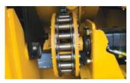
GUIDA DEL TAMBURO. Un sistema di quida della catena idraulica permette la fuoriuscita del tamburo per l'assistenza. I bulloni di serraggio dei pignoni possono essere sostituiti rapidamente, contribuendo ad abbassare i costi di manutenzione.
