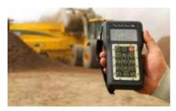
SISTEMA DI CONTROLLO. Gli operatori possono controllare la macchina sia tramite il display DP10 Vermeer montato sul pannello di controllo, sia tramite un ricetrasmettitore manuale remoto. Con entrambi i controlli, l'operatore può scegliere fra quattro pre-impostazioni programmabili o gestire le regolazioni manualmente, a seconda del materiale in entrata.
