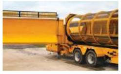
**ACCESSO ALLA MANUTENZIONE DEL** TAMBURO. Un pannello laterale a cerniera singola espone la piena lunghezza del tamburo del vaglio dal livello del terreno per l'assistenza del tamburo e la sua rimozione.
