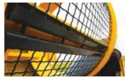
RETI IN TENSIONE. Con la capacità di tendere le reti del vaglio intorno al tamburo, l'operatore può aggiungere rigidità. Questo design consente l'uso di un filo più piccolo, incrementando la produttività.
