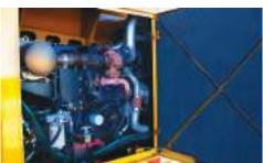
MOTORE. Il TR620 dispone di un motore Cummins QSB 3.8L Tier 4 Final da 120 hp (90kW). Il motore è montato su un telaio a perno che ruota di 30 gradi per un accesso migliore ai filtri del carburante e ai serbatoi idraulici per la manutenzione e l'assistenza.
