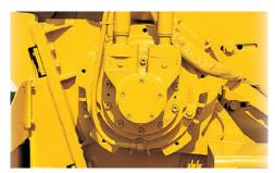
MOTORE ROTARY POWER. Un motore di comando del trencher Rotary Power e un albero con millerighe producono una velocità più bassa e una coppia più alta, fornendo quindi una maggiore penetrazione nel terreno e una minore usura della catena per ottenere migliori risultati di produzione.
