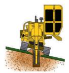
CINGOLI AUTO-INCLINANTI OPZIONALI. Una struttura oscillante dei cingoli permette loro di seguire la linea del terreno, consentendo uno scavo verticale con pendenze fino a 10 gradi.
