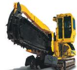
CABINA ROPM SOPRAELEVATA. La cabina sopraelevata con modulo di protezione dal ribaltamento trasversale (ROPM, RollOver Protective Module) è dotata di vetri LEXAN®, aria filtrata e pressurizzata, riscaldamento e aria condizionata. La posizione privilegiata della cabina permette una visuale virtualmente illimitata del braccio, dello scavo e del nastro trasportatore.
