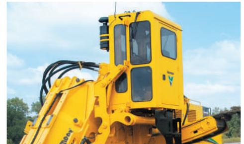
**CABINA ROPM SOPRAELEVATA.** La cabina sopraelevata con modulo di protezione dal ribaltamento trasversale (ROPM, RollOver Protective Module) è dotata di vetri LEXAN®, aria filtrata e pressurizzata, riscaldamento e aria condizionata. La posizione privilegiata della cabina permette una visuale virtualmente illimitata del braccio, dello scavo e del nastro trasportatore.
