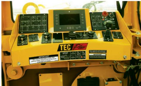
**SISTEMA ELETTRONICO DI CONTROLLO TEC® PLUS.** Il sistema operativo comunica con moduli di controllo multipli posizionati su tutta la macchina, consentendo la raccolta in tempo reale dei dati sul suo rendimento e capacità avanzate di risoluzione guasti.
