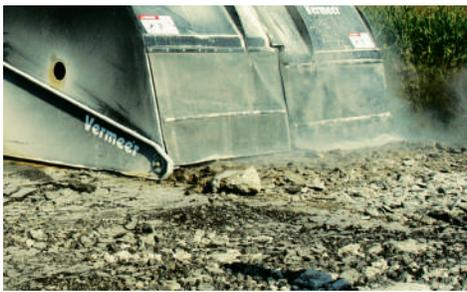
**ACCESSORIO DI FRESA DA SUPERFICIE TERRAIN LEVELER®.** Il T1155III ha un'opzione per l'attrezzo accessorio Terrain Leveler con trasmissione a catena, adatta ad applicazioni relative a scavi di grandi rocce incluse l'estrazione in superficie, la rimozione del terreno di copertura, la preparazione del sito dei lavori e la demolizione di strade.
