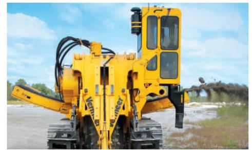
**OPZIONI RELATIVE AL PONTE SEZIONATO.** In aggiunta ai bracci di scavo sezionati, il ponte sezionato può essere regolato per ottenere diverse profondità di scavo.
