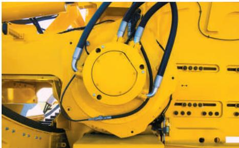
**MOTORE ROTARY POWER.** Un motore di comando rotante Rotary Power e un albero con millerighe producono una velocità più bassa e una coppia più alta, fornendo quindi una maggiore penetrazione nel terreno e una minore usura della catena per ottenere migliori risultati di produzione.
