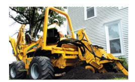
**OPZIONI PER GLI PNEUMATICI.** RTX550 è disponibile con pneumatici standard da 78,7 cm. Per un minore rischio di affondamento è possibile scegliere l'opzione con pneumatici da 88,9 cm. Inoltre il trencher è disponibile con il sistema a quattro cingoli, ideale per terreni irregolari.
