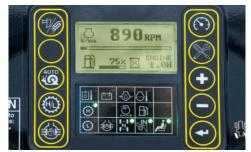
DATI SUL DISPLAY. Abilita l'operatore a scorrere con facilità le informazioni di diagnostica della macchina e quelle relative alle prestazioni. Il display multilingue può essere visualizzato in varie lingue in base alle preferenze dell'operatore.
