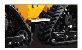
SPERIMENTATE LA DIFFERENZA. Quando viene utilizzato l'innovativo sistema a quattro cingoli, l'RTX550 offre un minore rischio di affondamento, una riduzione dei danni alla superficie, un aumento dello sforzo di trazione e maggiore stabilità. Le quattro ruote sterzanti e la sterzata a granchio mantengono la loro funzionalità col sistema.
