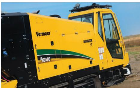
**AUMENTO DELLA POTENZA.** Il D60x90 S3 vanta un aumento di potenza pari a 12,7 kW rispetto al suo predecessore, il D60x90, fornendo agli operatori una potenza maggiore per effettuare perforazioni anche in condizioni di terreno difficili.
