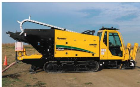
**RAPPORTO POTENZA/DIMENSIONI IMPRESSIONANTE.** Con 267 kN di spinta/tiro-posa e 12.202,4 Nm di coppia di rotazione, il D60x90 S3, largo solo 254 cm e lungo 7,9 m, è idoneo a una grande varietà di caratteristiche di installazione, anche in aree urbane congestionate.
