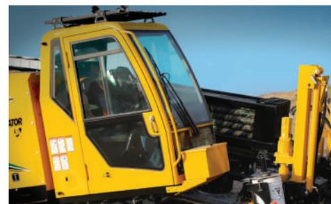
**MOLTO PIÙ SILENZIOSO.** Il D60x90 S3 presenta un livello di potenza sonora garantito di soli 107 dB(A) (12 db(A) in meno rispetto al suo predecessore, il D60x90), il che riduce il livello di rumorosità all'orecchio dell'operatore (pari a 83 dB(A)), aumentando il comfort dello stesso e riducendo la confusione nelle aree residenziali o urbane.
