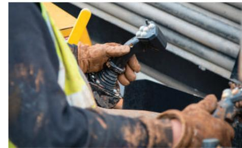
**COMANDI DI CONTROLLO TRADIZIONALI.** Per aumentare l'efficienza degli operatori e facilitarne la formazione, il D23x30 S3 è caratterizzato da due leve di comando e da un quadro di controllo comuni a tutta la linea di perforatori Navigator. Il design del sistema impiega una quantità inferiore di cavi e di fusibili per aumentare l'affidabilità.
