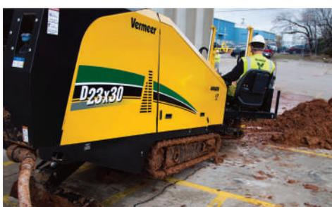
**PICCOLO MA POTENTE.** Il D23x30 S3 è caratterizzato da un design stretto e corto; il suo motore Deutz da 100 hp (75 kW) fornisce la potenza necessaria per lavorare in condizioni di terreno difficili.
