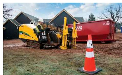
**MASSIMIZZARE LA PRODUTTIVITÀ.** Con 106,8 kN di spinta/tiro-posa e 4.067,5 Nm di coppia di rotazione, il D23x30 S3 presenta un notevole aumento di potenza rispetto al suo predecessore, il D20x22 Serie II, contribuendo a massimizzare la produttività della macchina e del cantiere.
