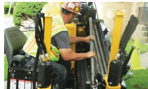
**OPZIONI DIVERSE DI ASTE.** Completa il tuo perforatore con aste Firestick da 1,8 m, diametro 4,2 o 3,3 cm e risparmia tempo grazie alla capacità di carico di 55 m di aste sulla macchina.
