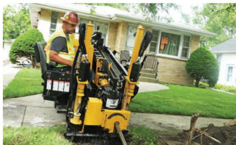
**MAGGIORE POTENZA.** Equipaggiato con motore Kohler da 48 hp (35.8 kW), questo perforatore offre una coppia di torsione pari a 1627 Nm (1200 ft-lb) e una forza di tiro/spinta pari a 3563,9 kg (7850 lb).
