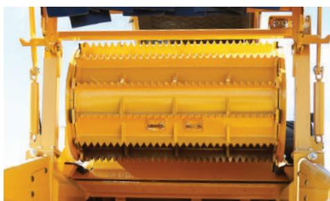
**ALIMENTAZIONE OTTIMIZZATA.** La planetaria del rullo di alimentazione è sigillata, per maggiore protezione dai detriti. Presenta uno spazio più stretto tra il rullo e la camera di triturazione, contribuendo a ridurre le possibilità di intasamento e di trascinarsi del materiale sul circuito del rullo.
