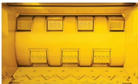
**PRODUZIONE DI CIPPATO.** Il tamburo per cippato "chip drum" opzionale produce cippato in quantità consistenti, ottenendo materiale idoneo per essere utilizzato per esempio come biocombustibile.
