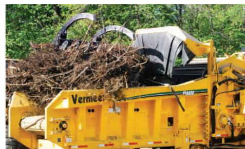
**TRATTAMENTO PROGRESSIVO.** Il Sistema brevettato SmartFeed controlla i giri motore (rpm) e regola la velocità di triturazione per aumentare la produttività. Il piano di carico aperto e largo facilita il carico del materiale.
