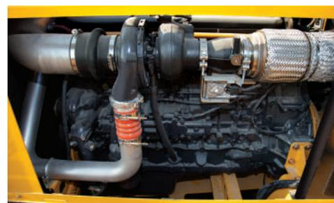
**MOTORE POTENTE.** Il motore Tier 4 Final con tecnologia Fiat Powertrain (FPT) fornisce 515 hp (384 kW) di potenza, per far fronte ad ogni necessità operativa.
