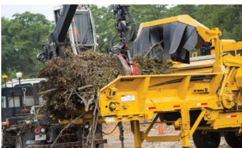
**TRATTAMENTO PROGRESSIVO.** Il Sistema brevettato SmartFeed monitora i giri motore (rpm) e regola la velocità di triturazione per aumentare la produttività. Il piano di carico aperto e largo facilita il carico del materiale.
