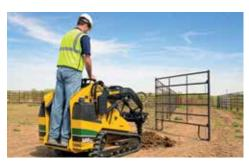
UN'APPOSITA PIATTAFORMA DOTATA DI AMMORTIZZATORI A MOLLA mantiene l'operatore al riparo da fango e detriti. Il sistema integrato di rilevamento dell'operatore arresta l'avanzamento nel terreno e il movimento del braccio di sollevamento/benna motorizzato quando l'operatore scende dalla piattaforma.
