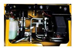
PAROLA D'ORDINE: MANUTENZIONE. Il pannello posteriore consente l'accesso al radiatore, ai componenti elettrici e alle valvole idrauliche. Se invece dovete accedere al motore, basta sollevare la protezione laterale per una facile manutenzione.
