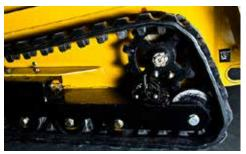
RIDUCI I COSTI OPERATIVI. Il carro è caratterizzato da una corona motrice del cingolo montata in alto. Il montaggio nella parte superiore riduce l'usura prematura e il danneggiamento dovuti a condizioni del suolo rocciose; la corona motrice è inoltre temprata in ghisa ADI per una maggiore durata.
