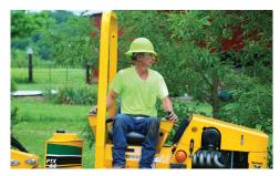
VISIBILITÀ DELL'AREA DI LAVORO. La postazione dell'operatore è allineata col centro dell'aratro, direttamente al di sopra del punto di articolazione della macchina, fornendo un'eccellente visibilità dell'intera area di lavoro.
