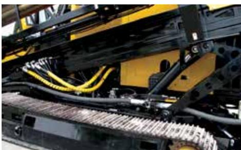
**AUMENTATE IL VOSTRO RAGGIO D'AZIONE.** Una griglia a quadrilatero articolato e cuscinetti aggiuntivi permettono agli operatori di impostare angoli di ingresso di 11 - 24°, aumentando il raggio d'azione ottenibile con i cingoli completamente a contatto col terreno.
