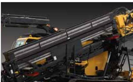
**CONTENITORI DELLE ASTE SOVRAPPONIBILI.** I contenitori sovrapponibili delle aste sono facili da utilizzare con un singolo perno e un bloccaggio automatico (in attesa di brevetto).
