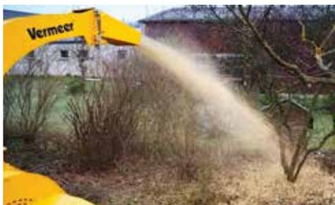
**CIPPATURA SENZA COMPROMESSI.** Collegando il motore Kubota da 48,1 hp (35,9 kW) a un disco dal diametro di 76 cm dotato di 4 lame, la BC190XL è in grado di trattare materiale con un diametro fino a 20 cm e di gettarlo ad una distanza minima 10 - 12 metri, tutto con un livello di rumorosità di soli 120 dB(a)!
