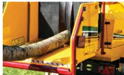
**SISTEMA DI ALIMENTAZIONE TOP.** Grazie a un'eccezionale apertura di alimentazione di 20 x 30,5 cm alimentata da rulli di alimentazione offset orizzontali di dimensioni superiori alla media nonché a un sistema di controllo SmartFeed con riserva automatica, questo modello ha la capacità e la potenza necessarie per fare il lavoro duro al posto tuo.
