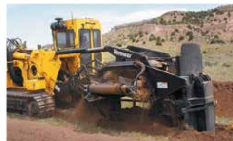
**RUOTA A CASSETTE OPZIONALE.** Progettata per l'installazione di condutture di diametro ridotto per l'uso nei campi in condizioni di scavo in un substrato morbido. L'accessorio ha la capacità di praticare scavi con una larghezza di 55,9 cm, 61 cm o 71,1 cm.
