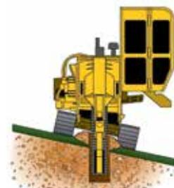
**CINGOLI AUTO-INCLINANTI OPZIONALI.** Una struttura oscillante dei cingoli permette loro di seguire la linea del terreno, permettendo uno scavo verticale con pendenze fino a 10 gradi.
