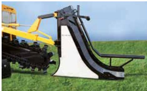
**ACCESSORIO POSACAVI.** Un accessorio posacavi opzionale permette al T655III di installare direttamente cavi e condotte subito dopo il taglio.
