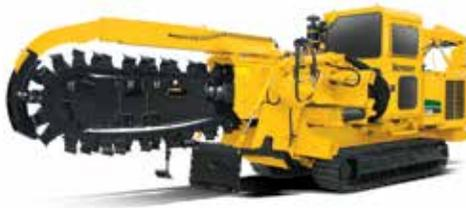
**PERFORMANCE DI TAGLIO DALL'OFFSET SCORREVOLE ESCLUSIVO** Il T558 è l'unico trencher dall'offset scorrevole nella sua categoria in grado di scavare trincee oltre il proprio lato sinistro fino a 22,9 cm con una regolazione della catena di 61 cm.
