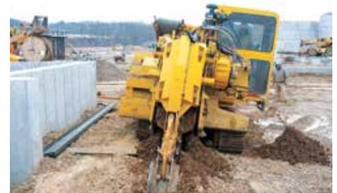
**CABINA SCORREVOLE ORIZZONTALE.** Una larga cabina ad aria pressurizzata/filtrata scorre orizzontalmente di 61 cm per offrire all'operatore maggiore visibilità.
