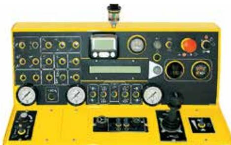
**SISTEMA ELETTRONICO DI CONTROLLO TEC® 2000.** TEC 2000 è un sistema di controllo a micro-processore che monitora le condizioni operative e comunica all'operatore in tempo reale i dati relativi al rendimento della macchina allo scopo di aumentare la produttività e ridurre l'usura del dispositivo.
