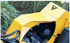
RIDUZIONE DEI TEMPI DI MANUTENZIONE E DI SOSTITUZIONE PARTI. Si sa, la manutenzione non è un optional. Il design della protezione del motore consente l'accesso ai punti di manutenzione quotidiana e settimanale senza l'utilizzo di strumenti, accelerando i tempi di assistenza.
