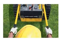
SISTEMA DI STERZO VZ. Invece di utilizzare leve aggiuntive e volanti, l'operatore può manovrare la macchina usando solo due barre manuali, che forniscono una leva maggiore quando si lavora in terreni sfavorevoli.
