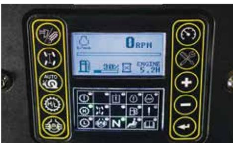
**DATI SUL DISPLAY.** Un display integrato consente all'operatore di ottimizzare la performance della macchina mediante la regolazione dell'accessorio in uso e dei parametri dell'avanzamento nel terreno; inoltre, fornisce informazioni diagnostiche sulla macchina stessa, come i giri/min del motore, il livello del carburante, la tensione della batteria, la temperatura del refrigerante del motore e le ore del motore.
