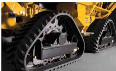
**VANTAGGI DEL SISTEMA A QUATTRO CINGOLI.** Il sistema opzionale a quattro cingoli permette di ridurre i danni alla superficie del suolo e di aumentare lo sforzo di trazione.
