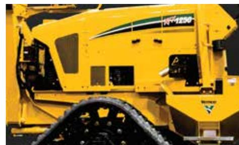
**AUMENTO DELLA POTENZA.** Quando il motore dell'RTX1250 cala sotto carico da 2.500 giri/min a 2.300 giri/min, i cavalli aumentano da 120 hp (89 kW) a 125 hp (93 kW), al fine di avere la massima potenza in modalità lavoro.
