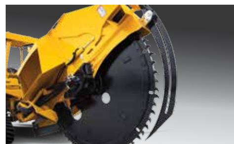
**UN ACCESSORIO PER OGNI TIPO DI LAVORO.** L'RTX1250 dispone di un grande numero di accessori per svariate applicazioni (dischi tagliaroccia, aratri, strumenti combinati e trencher).
