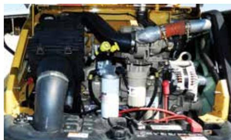
**MOTORE.** Dotata di un motore di azionamento Diesel Cummings Stage III B 97 kW (130 hp), la macchina BC1500 può gestire i materiali più duri con semplicità. Caratteristiche quali il sistema di controllo del motore Ecolde™, che porta il motore al minimo automaticamente dopo un minuto o cinque minuti di inattività, riduce il rumore nonché le emissioni di gas a effetto serra e migliora l'efficienza del carburante.
