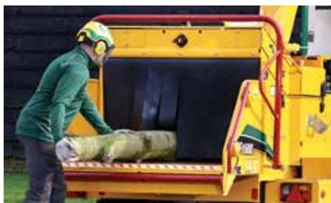
**SISTEMA SMARTFEED.** Il sistema SmartFeed monitora il numero di giri del motore (giri/min), arrestando e invertendo automaticamente i rulli di alimentazione per aumentare la produzione. Tale sistema rileva inoltre gli inceppamenti dei rulli di alimentazione e gestisce automaticamente il materiale per ridurre l'esigenza di utilizzare la barra di controllo manuale.
