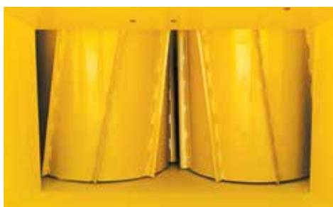
**RULLI DI ALIMENTAZIONE VERTICALI.** I rulli di alimentazione verticali con ganci elicoidali aiutano a trattenere il materiale saldamente sul piano di alimentazione, il che riduce le vibrazioni, gli urti e il carico strutturale sul retro della macchina.
