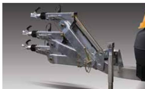
**GANCIO DI TRAINO EUROPEO REGOLABILE IN ALTEZZA.** Il freno di accoppiamento resistente, regolabile in altezza permette una regolazione rapida e semplice per l'adattamento a qualsiasi altezza del gancio di traino del rimorchio.
